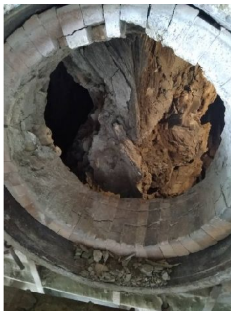
Рис. 1. Настыв в загрузочной части вращающейся печи
