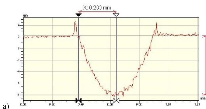
Рис. 4. Профиль дорожки износа образца с наплавленным слоем ПЭл1 (а) и ее трехмерное изображение (б)
